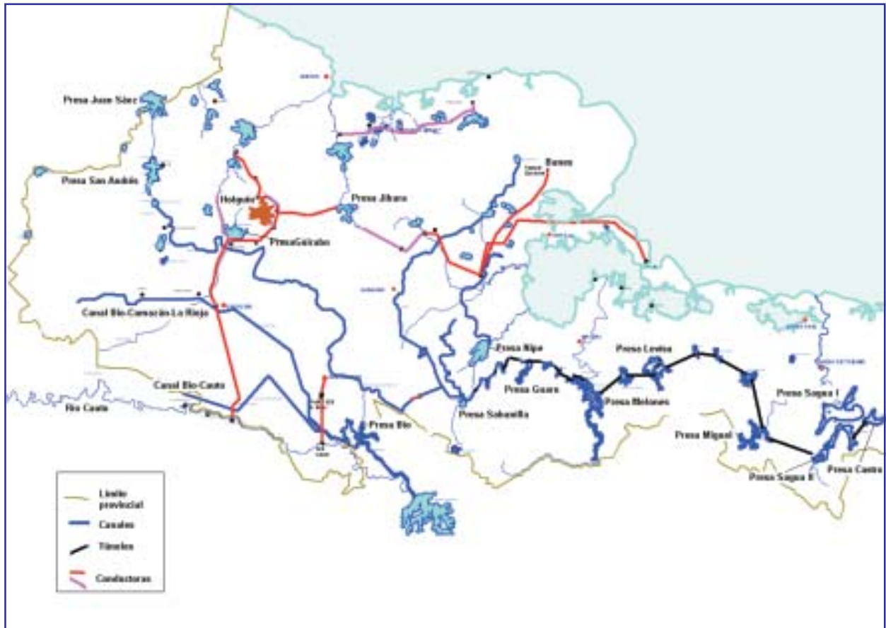
Fig. 1. Presas, túneles y canales del Traspase Este-Oeste (Etapa I y II).
